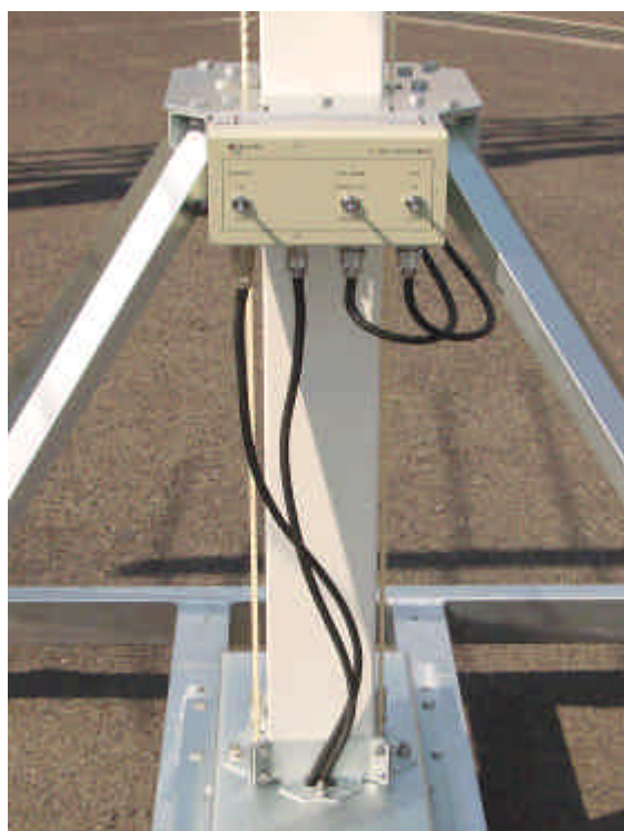
チルト, 偏波, アンテナ高の操作用コントローラ
