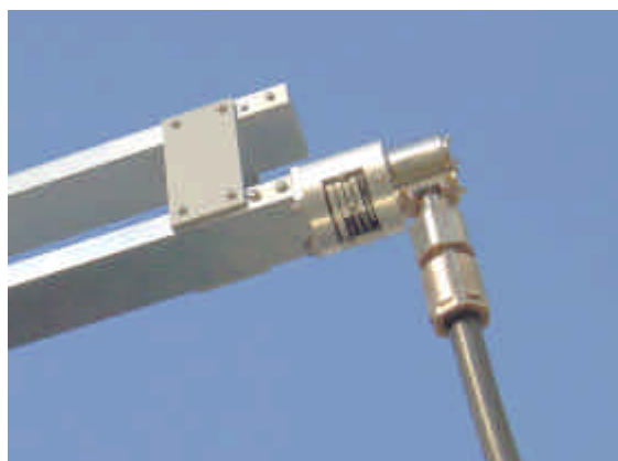
太い大型ケーブルに便利な給電部のロータリージョイント(オプション) 標準はNJコネクタ又は(LCJ)の下向型の為偏波切替時のケーブルの劣化を防止します。
