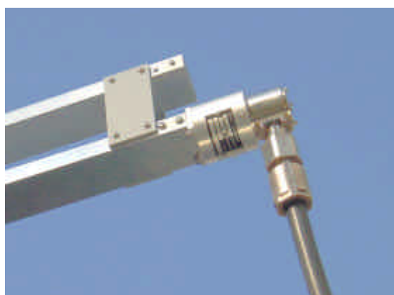
チルト, 偏波, アンテナ高の操作用コントローラ
